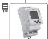
SHT-6 spínací hodiny s DCF signálem. Denní, týdenní, roční program, výstup 16 A. 1-kanalové. Str. 24.
