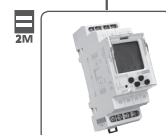
SHT-3, SHT-3/2 jako SHT-1, ale s denním, týdenním, měsíčním, ročním programem až do roku 2095. SHT-3/2: jako SHT-3, ale 2-kanalové. Str. 22.
