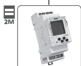
SHT-1, SHT-1/2 SHT-1: spín. hodiny s denním, týdenním prog., 1-kanál., výstup 16A přep. SHT-1/2: jako SHT-1, ale 2-kanalové. Str. 22.
