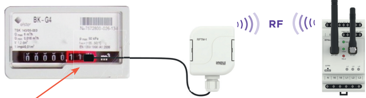
Umístění senzoru na plynoměru
