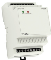
DAC3-04M Převodník ze sběrnice na signál 0(1)-10 V, 4 kanály, 1x teplotní vstup TC/TZ, 3-MODUL.
