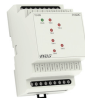
TI3-60M Jednotka pro připojení 6x senzor TC, TZ, Ni1000, Pt1000 nebo Pt100, 3-MODUL.
